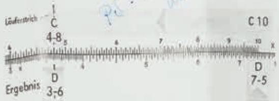
Lösung: Man stellt C 10 über D 7-5, schiebt den Läuferstrich über den 2. Faktor 4-8 auf C und liest darunter auf D das Ergebnis 36 ab.
